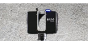
3Dレーザースキャナ 【地上部】3Dデータ化
