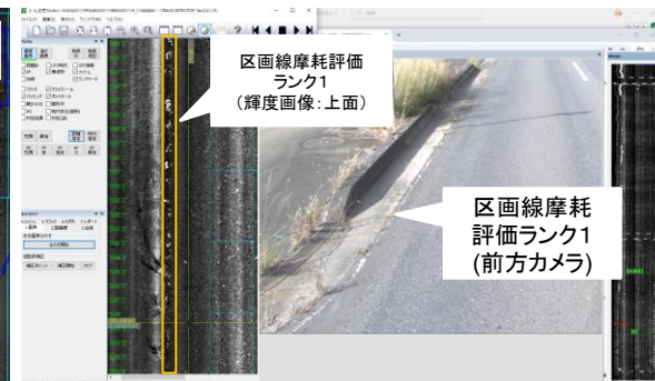
図3: 区画線摩耗検出のシステム画像
