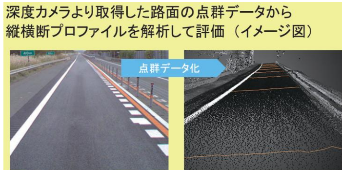
舗装路面を点群データ化したイメージ
