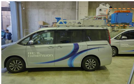
3Dカメラ (ひび割れ・わだち掘)
