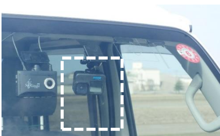
フロントガラスの内側にカメラを取り付ける(道交法上)
