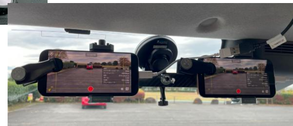
ひび割れ率、わだち掘れ量 (iPhone 2台)
