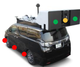
路面カメラ (ひび割れ)
