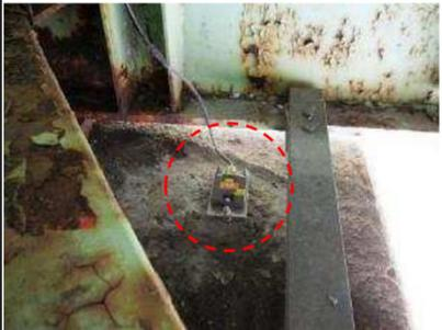
写真-1.3 傾斜計設置状況
