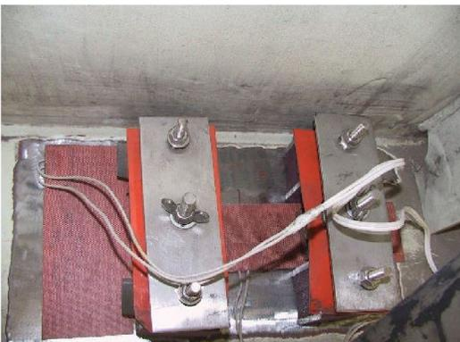
写真-3 疲労センサー貼付状況(加温)
