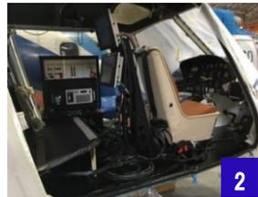
航空レーザ測深機器構成及び移動装置(回転翼機)への搭載状況
