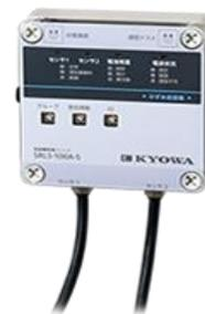
本技術は、トンネル、ダムなどの構造物の計測向けに、見通し距離500m程度をLoRa方式により無線化できる計測技術である。対象は、ひび割れ変位、荷重、圧力、水位、応力、電圧等である。送信機1台で2個のセンサーに対応でき、受信機1台で送信機10台に対応できるため、1グループあたり20個のセンサーを無線データ集録ができる。さらにこのグループを最大10グループ同時運用できるため、1つのエリアにて最大200個のセンサーを無線データ集録ができる。送信機の内部電池により、1Hに1回の計測で1年メンテ不要。通信不良があった場合にも送信機内部のメモリに記録が残り、欠測することはありません。
