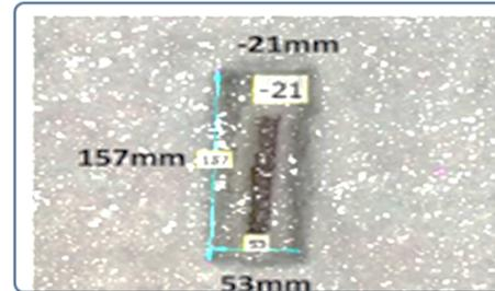
点群データから寸法計測と求積
