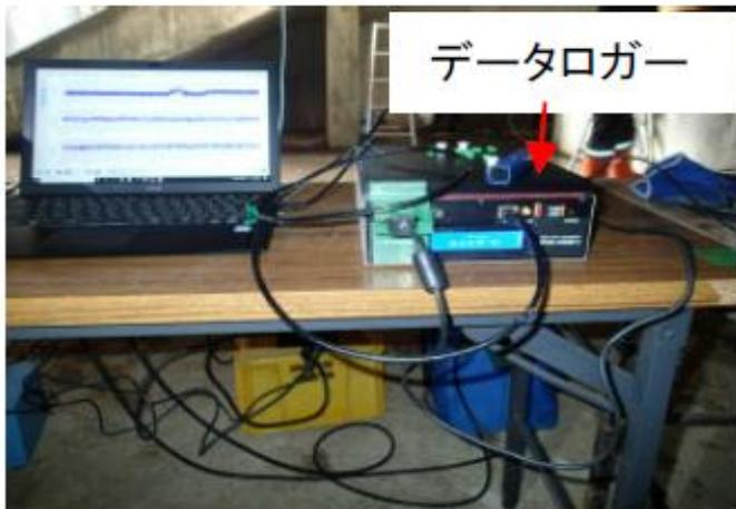
本技術は、桁、支承、橋脚等にセンサーを取り付け、データロガーを介し、PCへ収録する技術である。測定対象は、変位やひずみが対象。ガスセルを内蔵しており、そのガスセルにより常に校正する方式を採用。接触抵抗の影響もなく、長期観測も必要に応じてデータロガーに接続し、絶対量で計測できる優勢を持つ。
