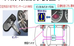
タイヤ空気圧監視装置 (2021.3)
