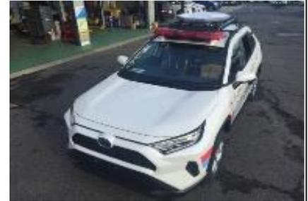
移動型衛星通信設備(Car-SAT)
