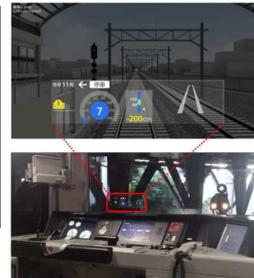
ドライバレス運転の実現に必須となる高性能な自動列車運転装置(ATO)の開発に向け、山手線 E235 系を使用した試験走行を山手線全線で実施(JR東日本)
