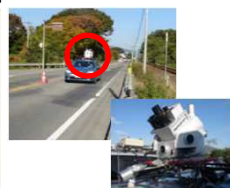
車載装置による 路面性状測定
