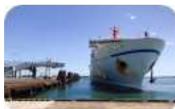
①自動離着機機能：大型旅客船(全長190m)の入出港操作を自動化
