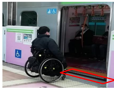
段差・隙間解消
