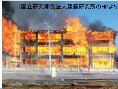
実大規模の火災実験
