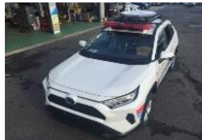
移動型衛星通信設備(Car-SAT)
