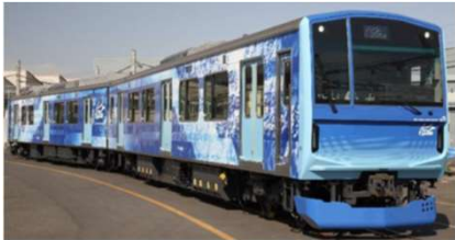
水素燃料電池鉄道車両(HYBARI)
