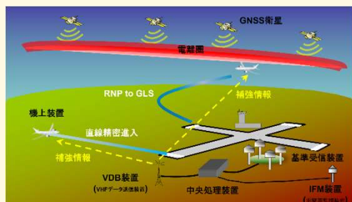
衛星を用いて滑走路へ誘導する地上航法装置
