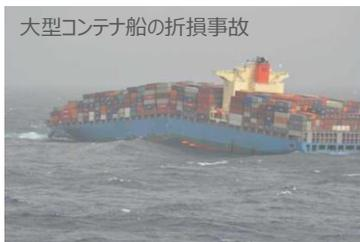
大型コンテナ船の折損事故
