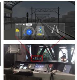
ドライブレス運転の実現に必須となる高性能な自動列車運転装置(ATO)の開発に向け、山手線 E235系を使用した試験走行を山手線全線で実施(JR東日本)
