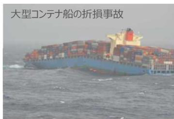
大型コンテナ船の折損事故
