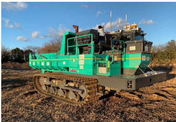
遠隔操作型運搬ロボット（左）と、本体工事中のハツ場ダム（右）
