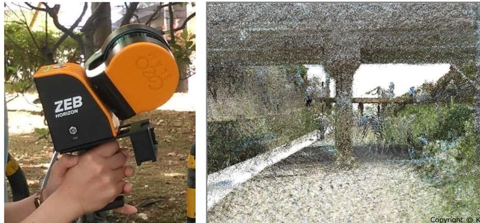
手持ちレーザスキャナによるレーザ点群計測イメージ
