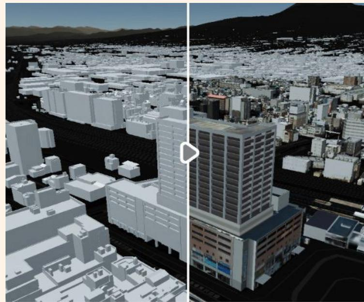
左) LOD2: 屋根形状の凹凸が、正確に表現できている。セマンティクスとして、屋根・壁・床などの情報も持っている
