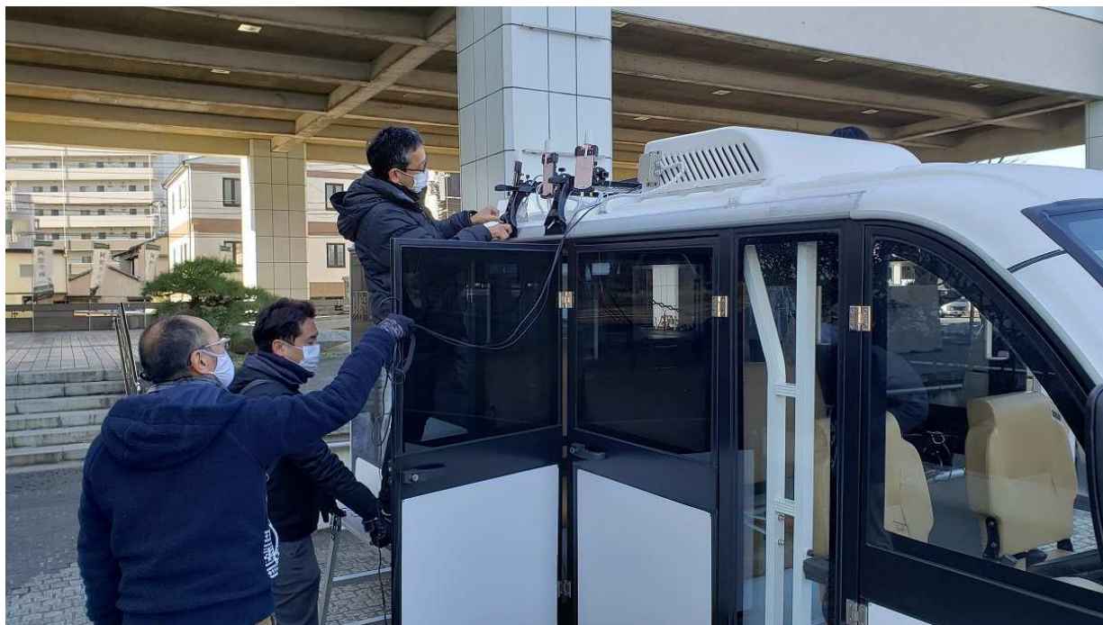
実験車両へのVPS機器設置の状況
