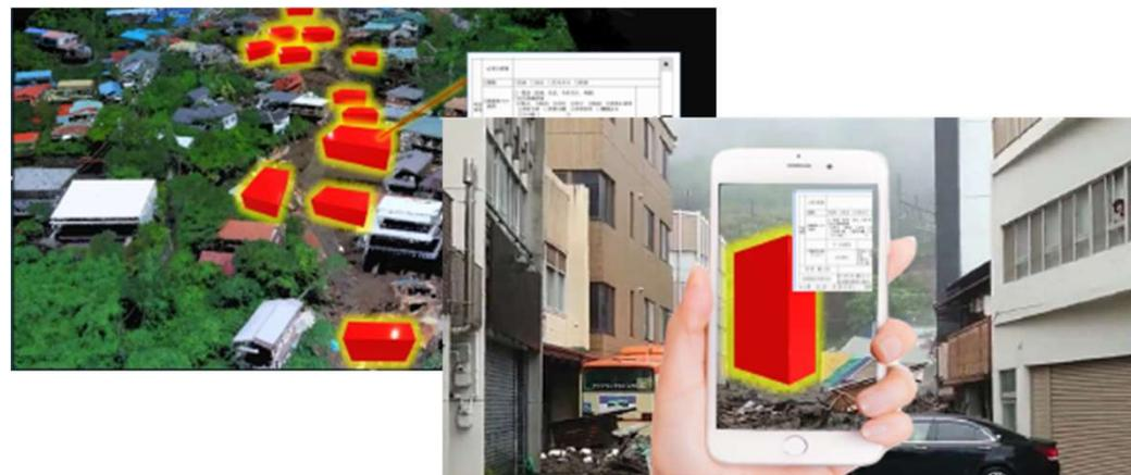
3D都市モデルと3D測量データを組み合わせた**被災状況の迅速な把握システムを開発し、災害救助等のオペレーションへ貢献**
