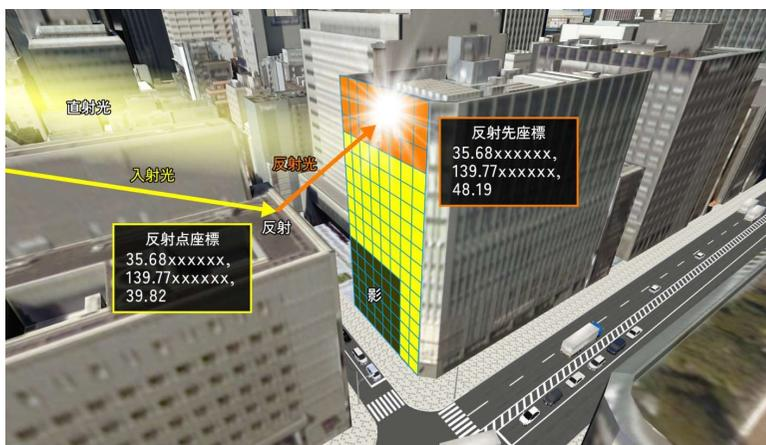
建物外壁への日照シミュレータを開発。**外壁タイル点検のための調査計画策定を効率化**させ、ドローンによる赤外線調査の普及・拡大を目指す
