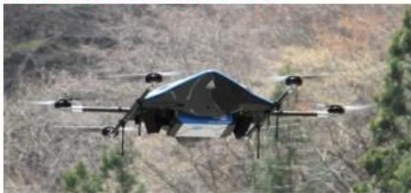
利用機体「AirTruck」1回最大4kgを運搬
