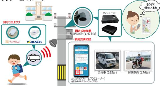
見守りBLEタグ、固定式検知器 (見守りカメラ (1,475台)、移動式検知器)、V2Xユニット、公営車 (265台)、郵便車高 (176台)、かごわがや (3,700ユーザー) (旧加古川市スマートシティ)
