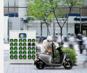
バッテリーステーション
