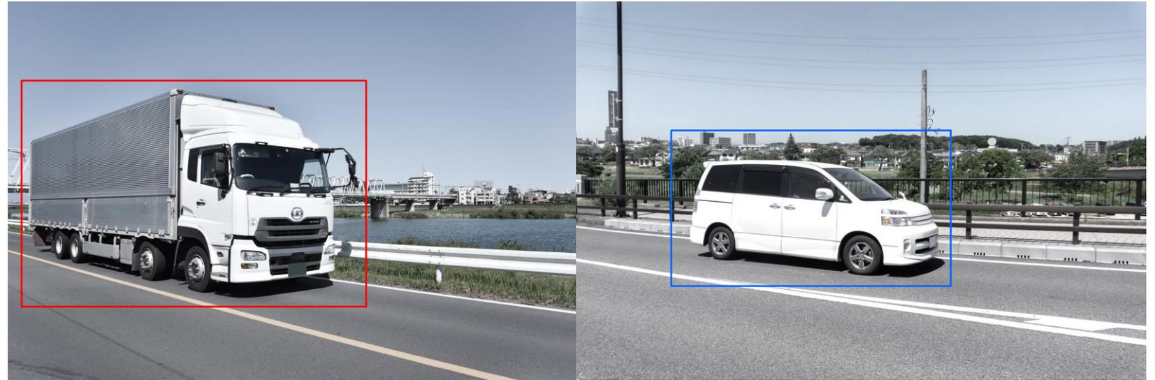
車種(大型車、小型車、二輪車(開発中))判定
