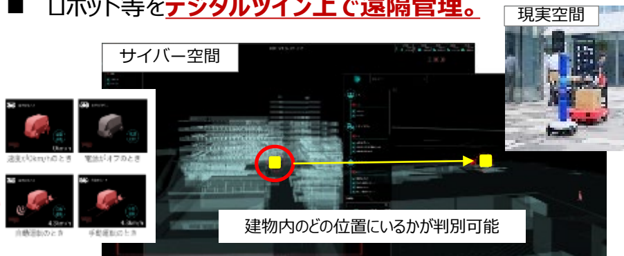
▲デジタルツイン上でロボット・自動運転バスをリアルタイムで管制
