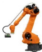
ピッキングロボット
