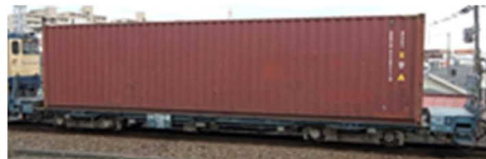
《国際海上コンテナを積載した低床貨車》
