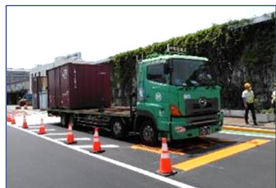
トラックスケールの設置 （偏積防止対策）
