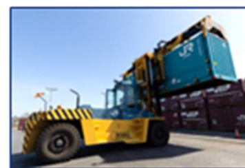
大型コンテナを取扱う荷役機器
