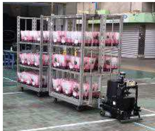
無人搬送機により 一貫流通台車を 搬送する様子
