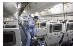
客室内椅子の取付・取外し
