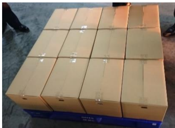
11型パレットへの 積付けパターン
