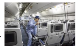
客室内椅子の取付・取外し
