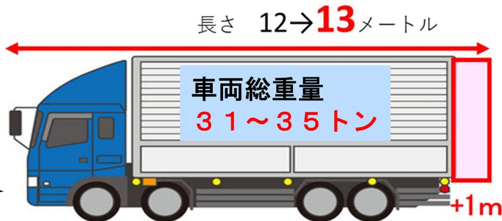
車両総重量 25トン + バッテリー + 車両重量増トン + 積載量増トン = 31~35トン
