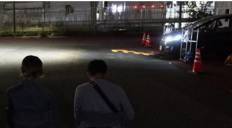
【信号灯路面描画評価実験の様子】
