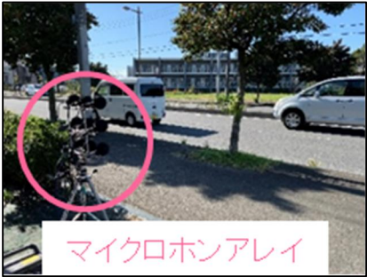
【図1 マイクロホンアレイを用いた測定の様子】
