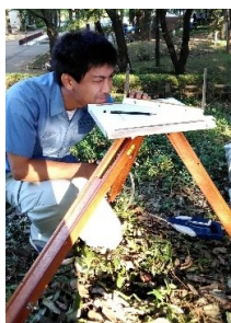
平板測量の様子
