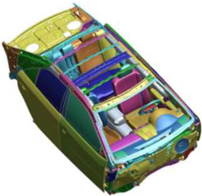
【スレッド試験の有限要素シミュレーションモデル】
