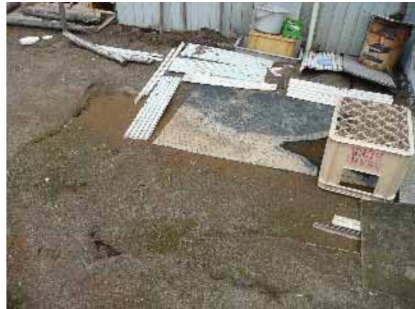
写真 5.26 写真 5.23 の敷地の噴砂痕
