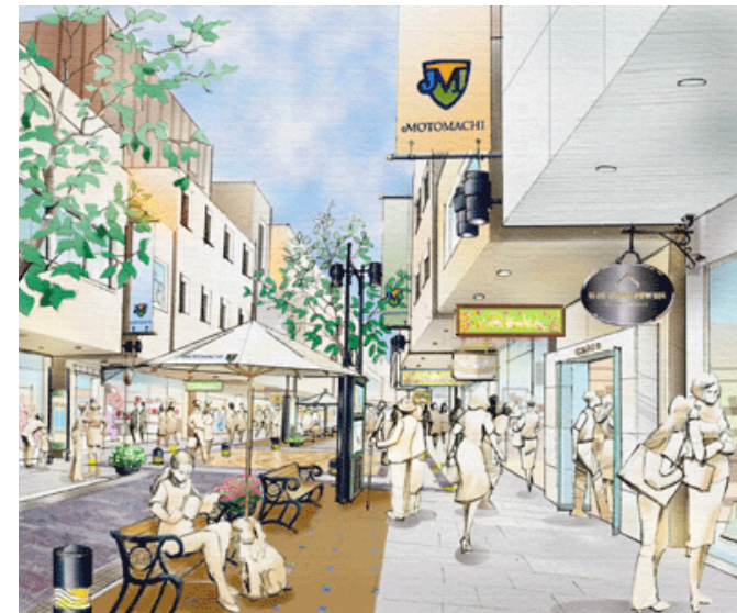
車道幅の縮小(8m → 5.5m)と民地の1階部分セットバック(1.8m)により歩行者空間を確保
