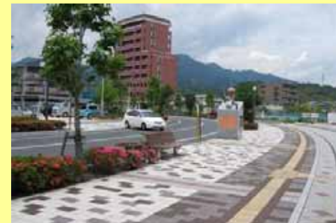
バリアフリーに対応した歩道が整備され、歩行者の安全も向上
