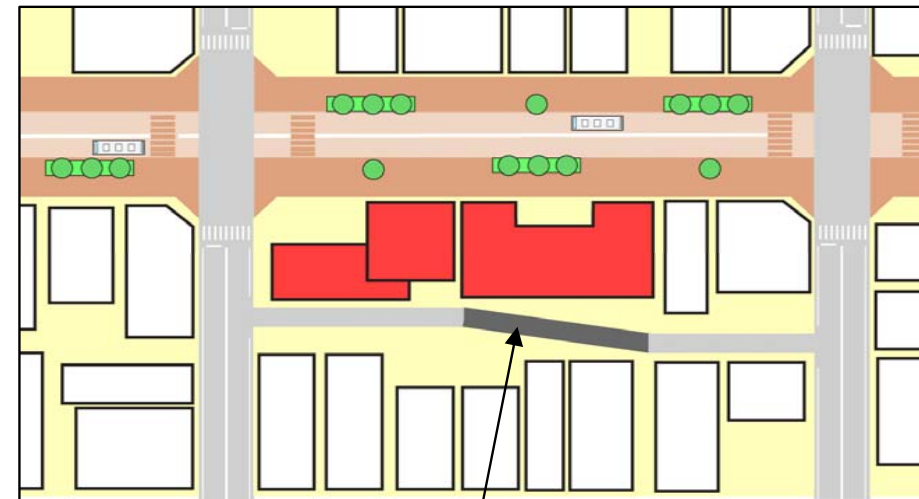
区画道路により裏側からの荷捌き車両等のアクセス確保
