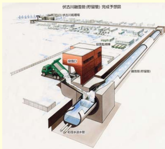
伏古川融雪管（札幌市）
