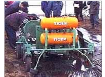
ビニールシートをかぶせた畝(うね)に穴を開ける機械
