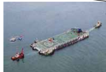
外洋曳航時の防災フロート
