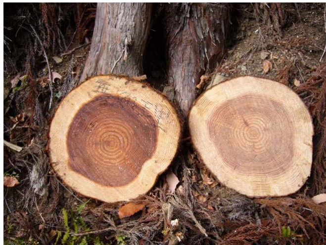
9月処理、1月末伐採直後のオビスギ(右側)、左側は比較のため伐採した無処理材
