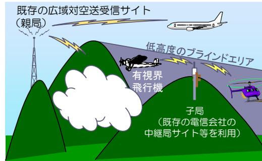
通信会社の中継サイト等に対空通信の子局を設置し、ブラインドエリアに通信サービスを提供
