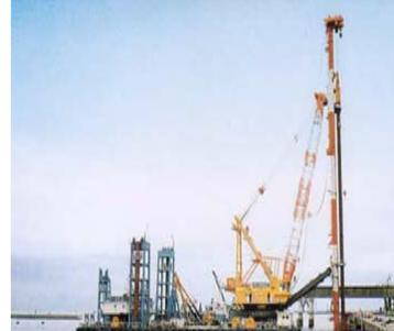
起重機船(杭打設に使用)高さ=122m
