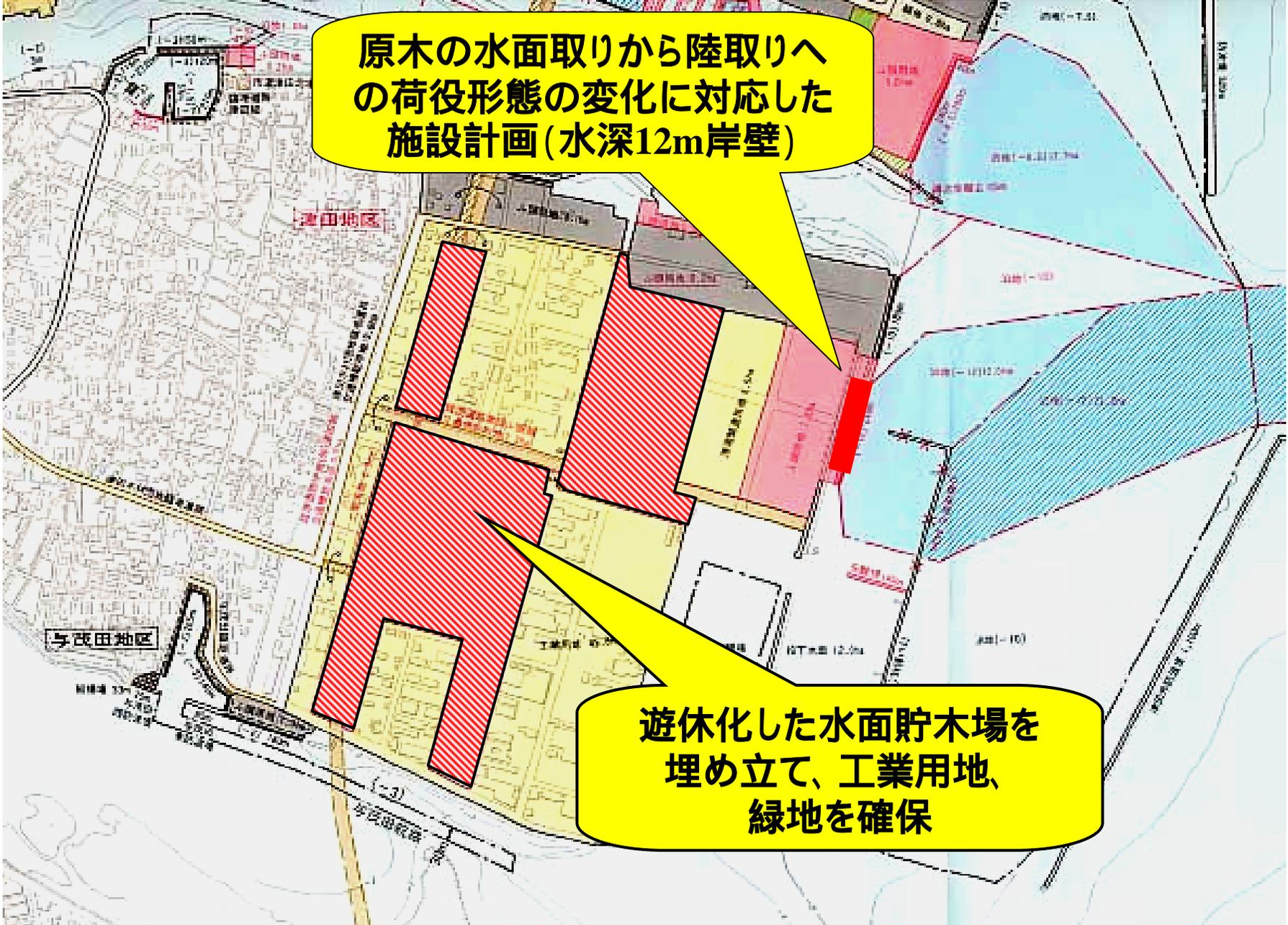
原木の水面取りから陸取りへの荷役形態の変化に対応した施設計画(水深12m岸壁)
