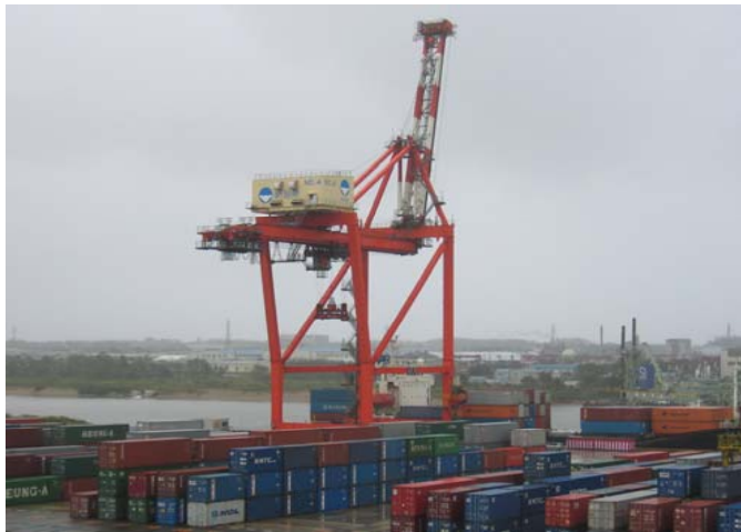
東京港から新潟港東港西ふ頭へ 移設されたコンテナクレーン （製作：H6年度、移設：H16年度）
