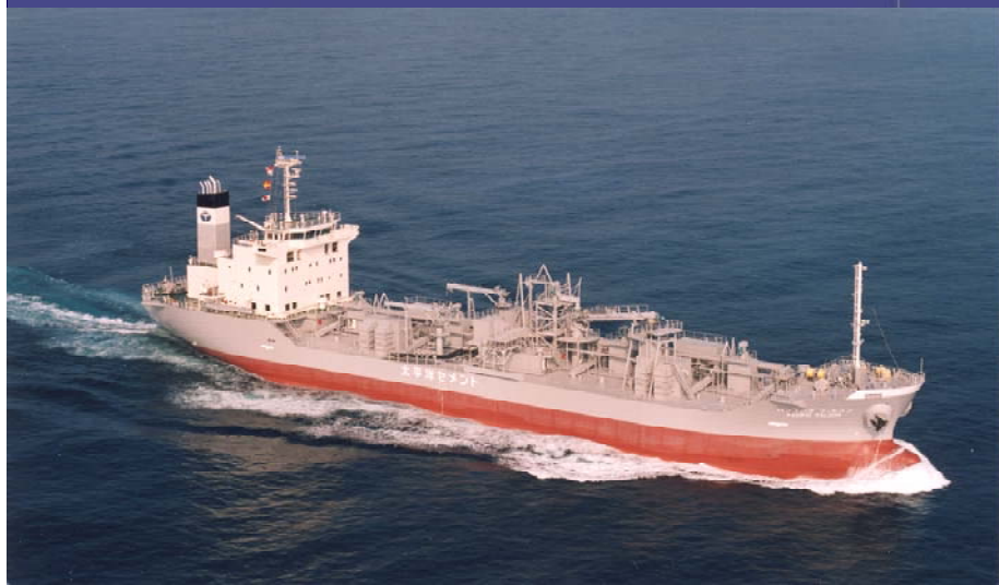
セメントタンカー：パシフィックファルコン 積載能力 10,000トン
