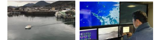
遠隔操縦船舶と管制車両からの操縦の様子
