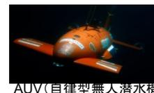
AUV(自律型無人潜水機)
