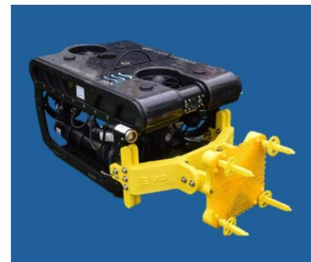
図2. 網目の破損部分を塞ぐ機体の写真 [2]
