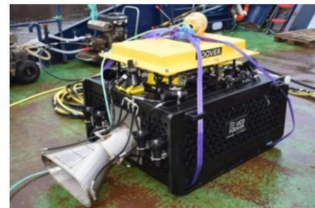
図1. へい死魚回収を行う機体の写真 [1]
