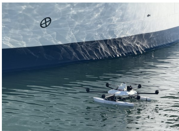
実証機体：水空合体ドローン
